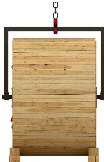
Figura 6.7-Maniobra para carga y descarga del carrete.
