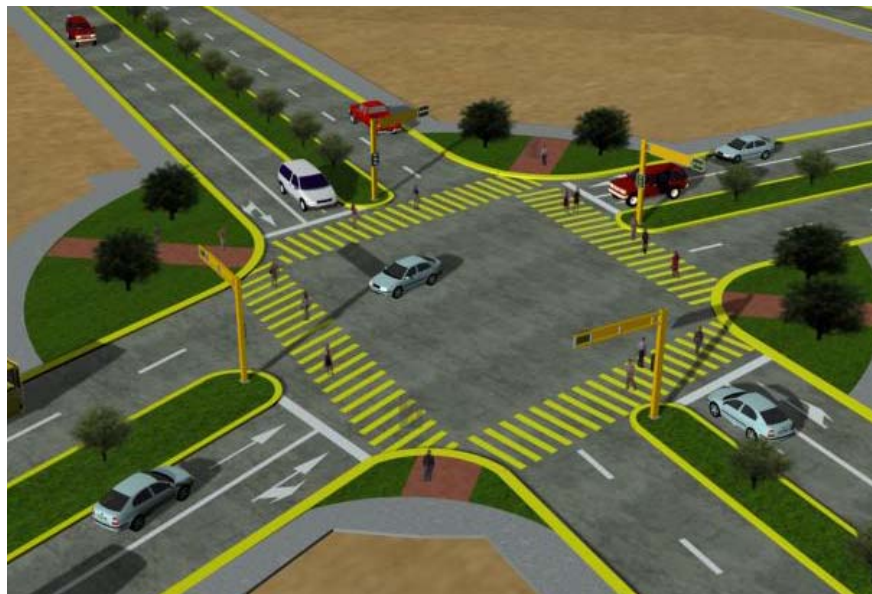
Figura 41: Ejemplo de semaforización y señalización en intersecciones
